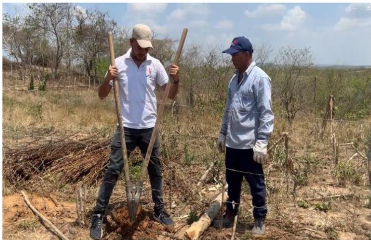
Figura 2a: uso de la paladraga y la observación de ángulos en el abrir de la herramienta
