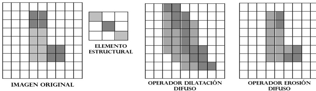
Figura 1. Ejemplo de aplicación de los operadores dilatación y erosión
