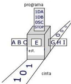
Figura 1. Dibujo conceptual de una máquina de Turing
