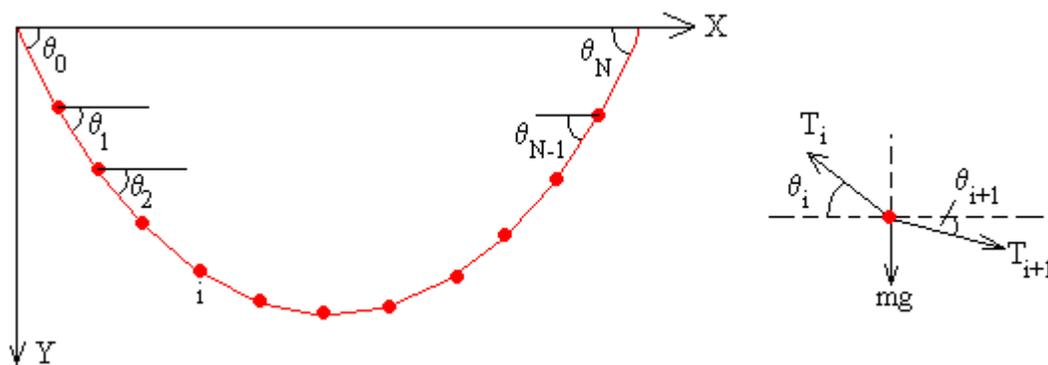
Figura 5. Fuerzas que actúan en la catenaria. Disponible en [http://www.sc.edu.es/sbweb/fisica/solido/din\\_rotacion/catenaria/catenaria.htm](http://www.sc.edu.es/sbweb/fisica/solido/din_rotacion/catenaria/catenaria.htm)
